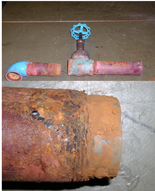
給水用ライニング鋼管で 生じる異種金属接触腐食
