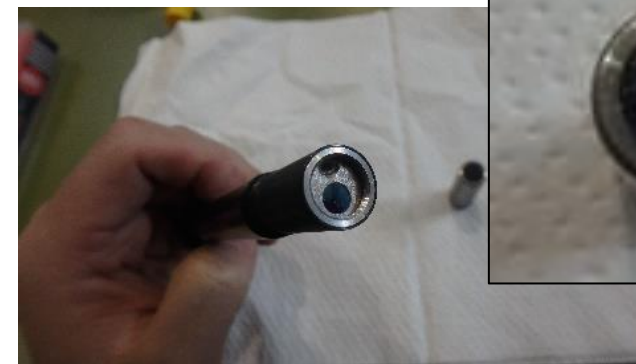
腐食センサ (分極抵抗法(電気化学))
