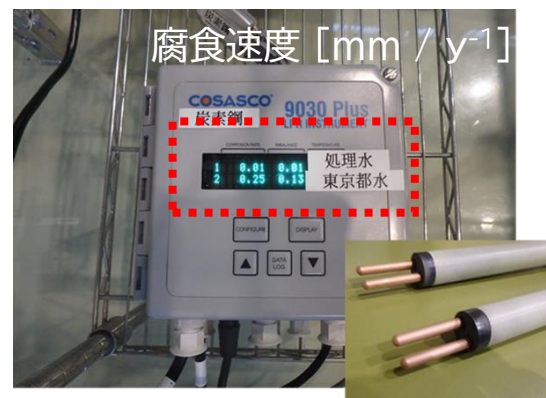
腐食センサ (分極抵抗法(電気化学))
