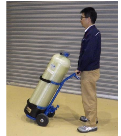
アニオン交換処理用装置 (アニオン交換樹脂 55L, 300φ×1,200mm)
