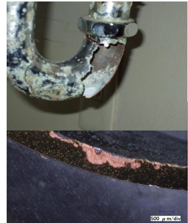
黄銅製衛生金物の 脱亜鉛腐食
