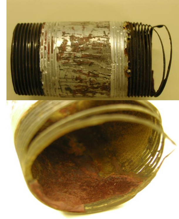
蒸気還水配管に生じる 炭酸腐食
