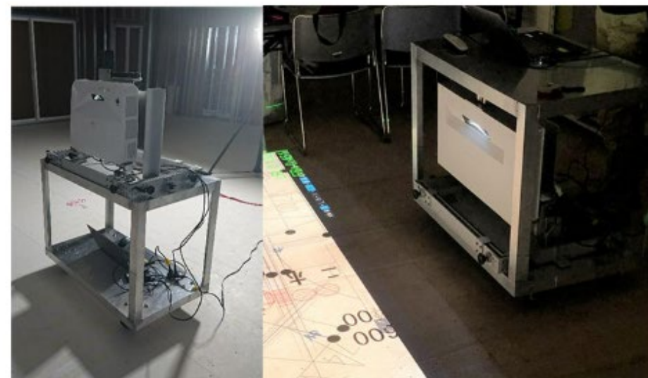
写真2 自動姿勢制御装置に固定したプロジェクター
