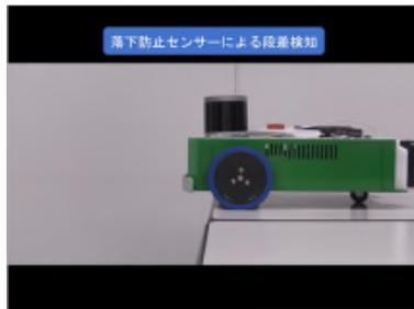
【落下防止センサーによる段差検知・停止の動画】
