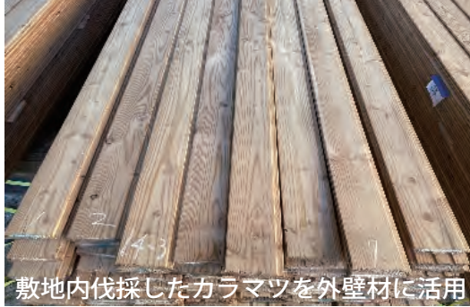
敷地内伐採したカラマツを外壁材に活用
