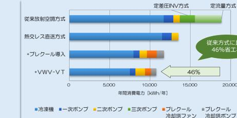
動的（ダイナミック）に往還温度差（レンジ）を可変することで、これまでの放射空調では十分な外気冷房が困難という課題を克服し省エネルギー性能を大幅に向上させることができました。さらに、従来の放射空調の課題であった「制御応答性の悪さ」、「熱交換の通過抵抗」、「低効率3次ポンプ設置」、「暖房/冷房切替時の煩わしさ」などの課題も解決若しくは改善しています。
