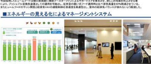
●BEMS+デジタルサイネージ エネルギーの見える化を実現させるためにBEMS+デジタルサイネージを導入した。エネルギー消費量をリアルタイムに可視化し、設備の運用改善や研究者のワークスペースの可視化を実現した。BEMS+デジタルサイネージを導入した。エネルギー消費量をリアルタイムに可視化し、設備の運用改善や研究者のワークスペースの可視化を実現した。
