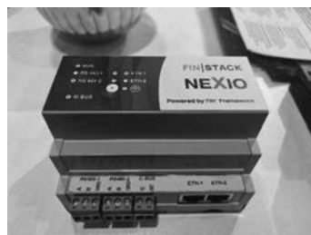
写真-23 FIN STACK 本体
